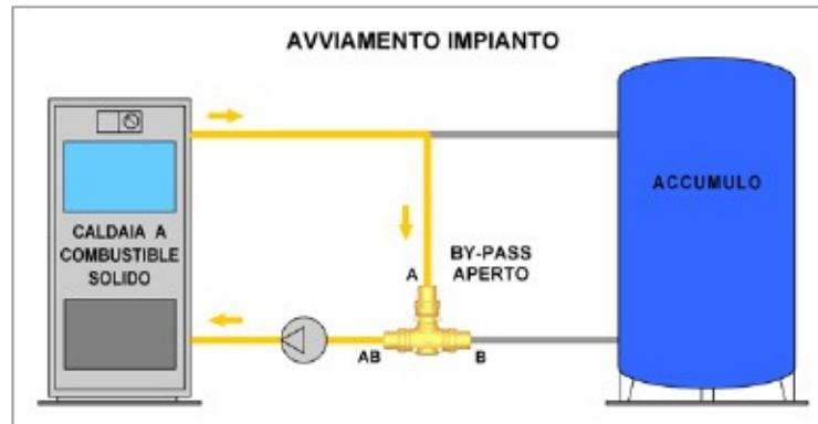
Коли температура теплоносія прямої лінії (A) перевищує значення настройки антиконденсаційного клапана, починає відкриватися трубопровід зворотньої лінії з системи (B) і вода прямої лінії з котла змішуються з холодною водою з системи (AB). Починається заповнення системи.
