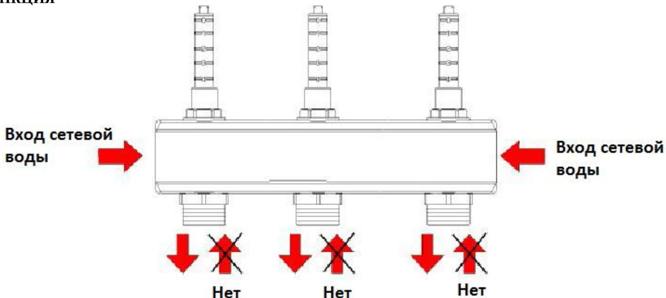
Расходомеры устанавливаются на коллекторах подачи в систему теплого пола и позволяют видеть в реальном времени объем циркулирующей воды в каждом контуре. Точность расходомера позволяет настроить расход воды на самый минимум. Расходомер имеется в 2-х вариантах: с расходом 0-4 л/мин и 0-8 л/мин.
