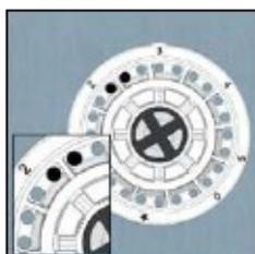
Для ограничения хода термоголовки и выбранной температуры, обратите внимание на два отверстия сразу после цифры обозначающей температуру.
