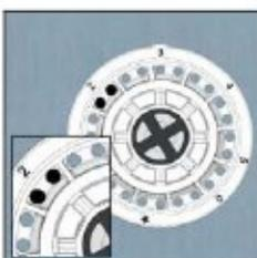
В нижней части термоголовки, те же цифры. Обратите внимание на отверстия, до и после выбранной цифры (на примере цифра 2).
