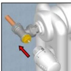
Установите термоголовку, таким образом чтобы индикатор был хорошо виден.
