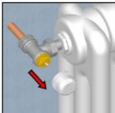
Снять ручку с вентиля и сохранить ее в качестве запасной части.
