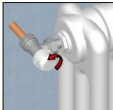
Открутить белую ручку против часовой стрелки, и снять ее с вентиля.
