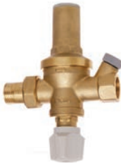
Подпиточный клапан со встроенным запорным клапаном и фильтром. Подключение манометра – 1/4. Макс. давление на входе 16 bar, давление на выходе регулируется от 1 до 6 bar. Фабричная настройка давления на выходе 1,5 bar, макс. Рабочая температура 90°C
