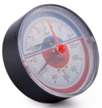
Термоманометр Ø 80. Фронтальное подключение. В комплекте с запорным клапаном. Шкала температуры 0-120°C. Шкала давления: 0-4 bar, 0-6 bar или 0-10 bar. Степень защиты: IP 34.
