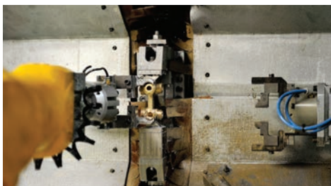
Изготовление корпуса двухтрубного вентиля для стального панельного радиатора.
