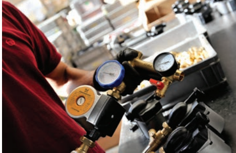
Сборка насосных групп для солнечных коллекторов.
