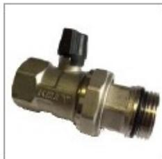
Шаровой клапан с патрубком и кольцевой прокладкой устанавливается на коллекторе. Необходим для отключения системы «тёплый пол» от котла или центральной котельной, в случае работ по замене или ремонту коллекторной группы.
