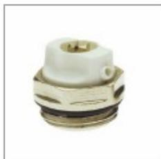
Ручные воздухоотводчики имеют микрометрическое открытие, они ориентируемые и оснащены специальной прокладкой для монтажа на коллекторе.
